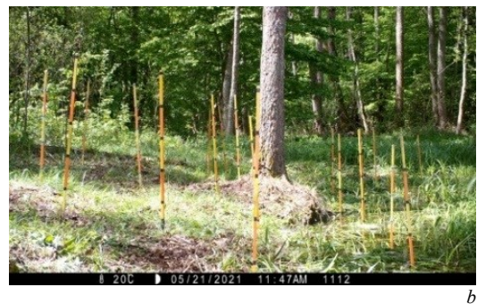
Рис. 1. Схема розташування калібрувальних жердин перед фотопасткою у секторі зйомки ( a ) і приклад, як це виглядає на місцевості ( b ).
