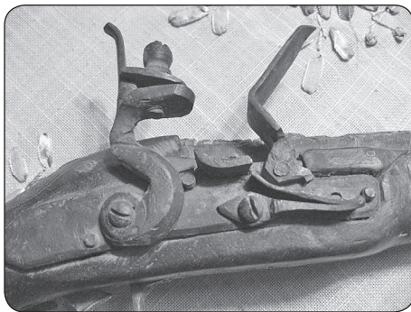
Загальний вигляд кремінного ударно-куркового запалу
