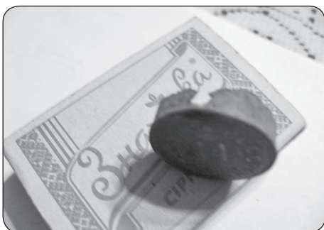
На денці набою видно отвір для голки, яка розбивала таблетку ударної суміші, що перебувала всередині набою
